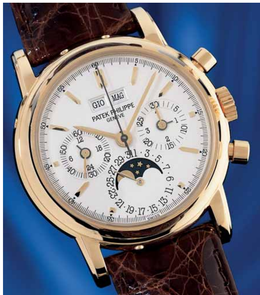
Il Cronografo con Calendario Perpetuo (Ref. 3970) impiega il calibro Patek Philippe CH 27-70 Q a carica manuale (24 rubini, 18.000 alternanze/ora, bilanciere Gyromax, ponti decorati a Côtes de Genève e rifiniti ad Anglage, platina decorata a Perlage). La cassa è in oro giallo a 18 carati, il prezzo è di 125.000.000 di lire.
