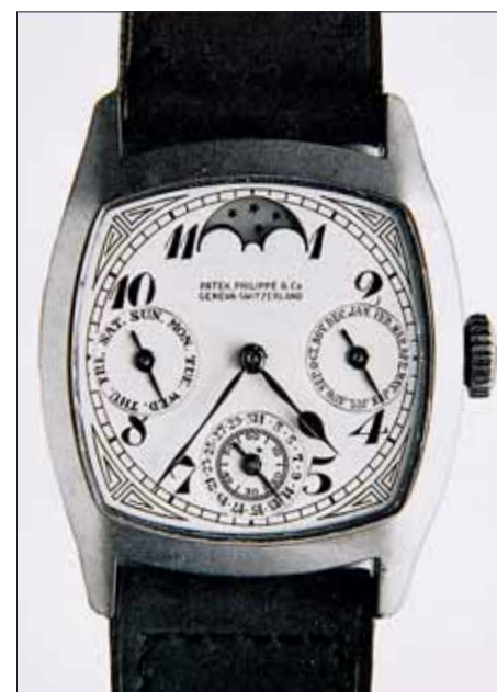
Orologio con calendario perpetuo e fasi di Luna, realizzato da Patek Philippe nel 1930; cassa cushion, quadrante con scala dei minuti a binario, indicazione delle fasi di Luna al 12 e piccoli secondi inseriti all'interno del quadrantino del datario situato al 6; èbauche di Victorin Piguet, movimento da 13", n. 198.167, bilanciere bimetallico e spirale Breguet.
