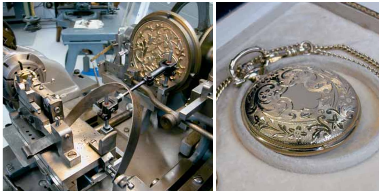
Il guilloché è una tecnica decorativa che viene ancora praticata per la decorazione di casse e fondelli. In fotografia si possono osservare il tornio manuale del 1931 che viene tutt'oggi impiegato per effettuare il guilloché e un orologio da tasca restaurato e decorato nell'atelier delle decorazioni della Patek Philippe, a Perly.
