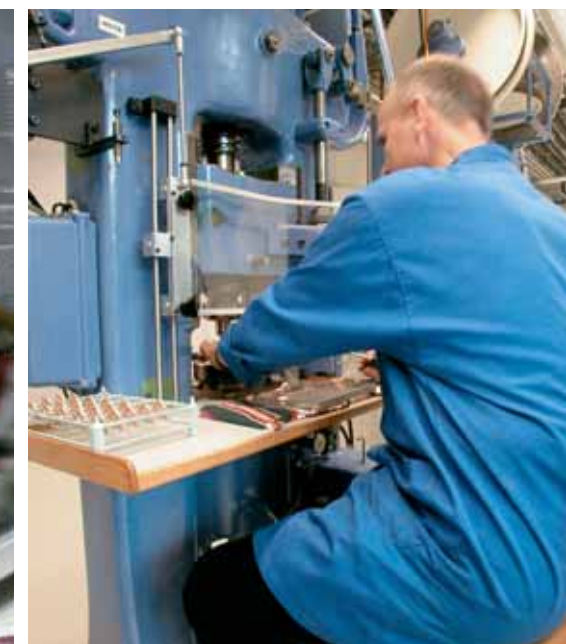
La prima operazione cui sono sottoposte le componenti in produzione a Perly è lo stampaggio, che si effettua su presse da 50 fino a 80 tonnellate. In foto vediamo lo stampaggio di un fondello in oro. Si tratta di un'operazione che dà al disco di metallo iniziale la forma desiderata mediante deformazione plastica, senza asportazione di materiale.
