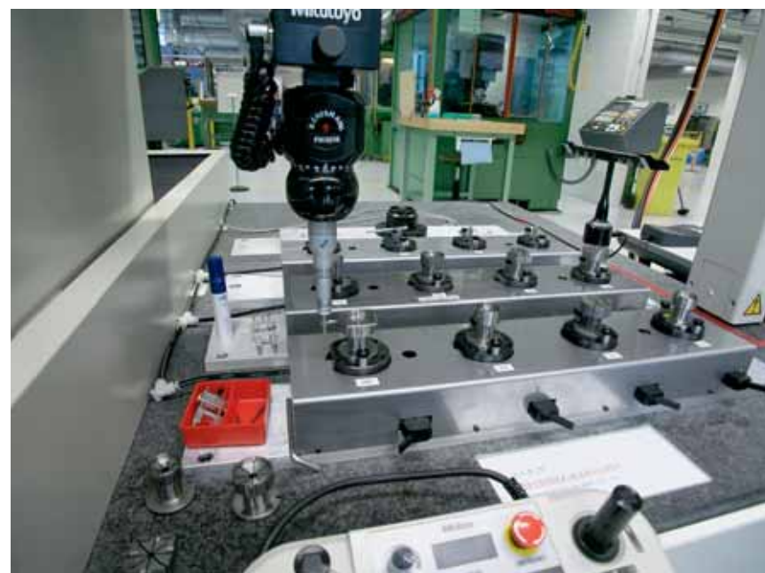
I pezzi completati vengono sottoposti a una verifica dimensionale su una macchina di precisione a sensori, che effettua delle rilevazioni tridimensionali con una risoluzione di 3 millesimi di millimetro.
